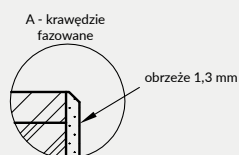
Przekrój ramienia skrzydła bezprzylgowego
