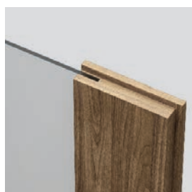
łączenie z szybą „na kant” skrzydło przylgowe
